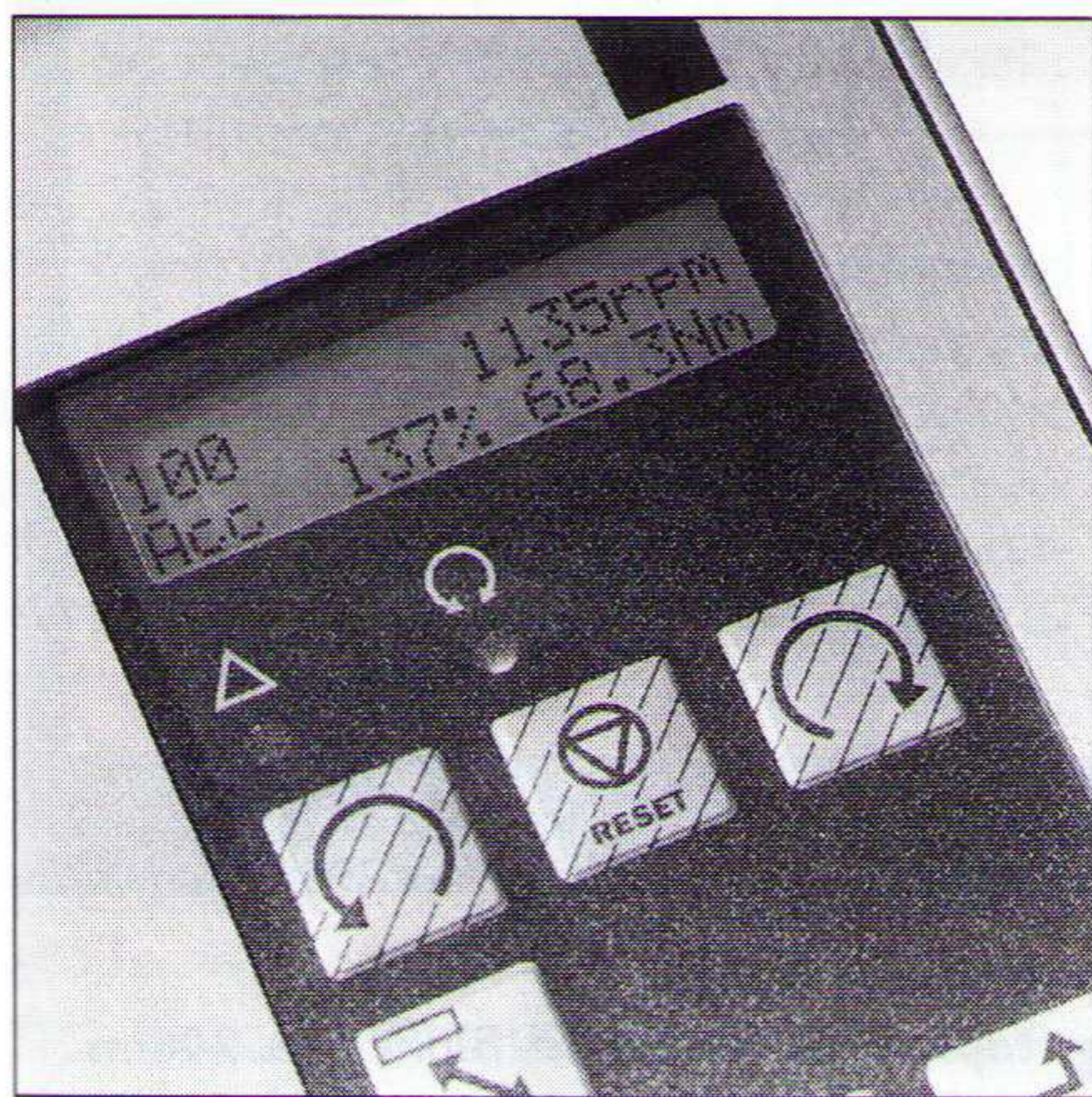
Fig. 3 (Afbelding van het bedieningspaneel) Nauwkeurige regeling van koppel en toerental van AC-motoren zonder sensoren op de as.
